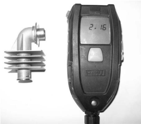
Fig. 2 Nuovo tipo di raffreddatore preliminare, visualizzazione della versione del software IC-Air
