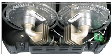
Fig. 7 Entrambe le cartucce installate con connettori dei cavi collegati
