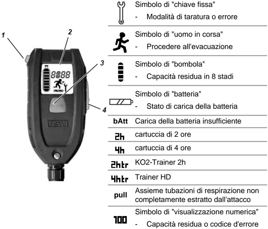
Fig. 9 Simboli IC-Air e di visualizzazione
